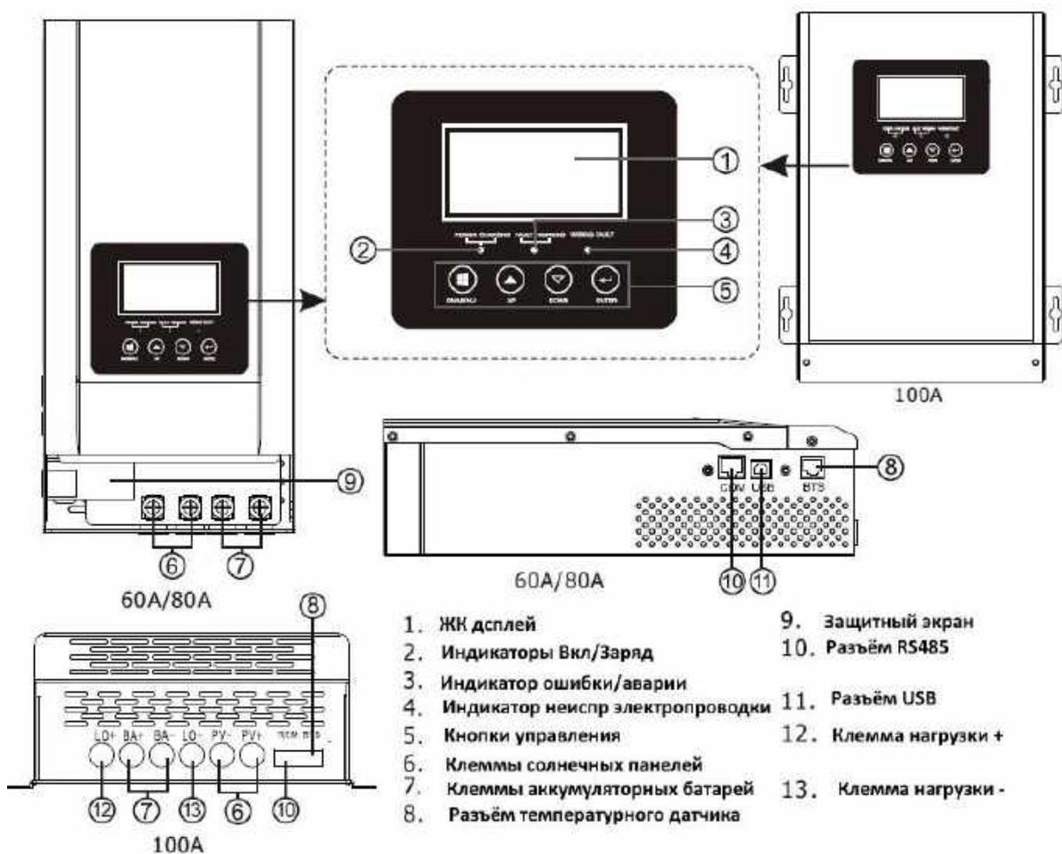
Рисунок 3 Присоединения и органы управления Must PC1800F
