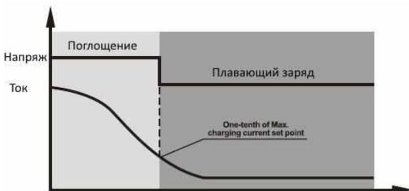
Независимо от того какой уровень тока заряда установлен, когда зарядный ток снизится ниже 10 А контроллер перейдёт в режим плавающей зарядки. Если продолжительность режима поглощения превысит установленное значение устройство сменит режим на плавающий.
