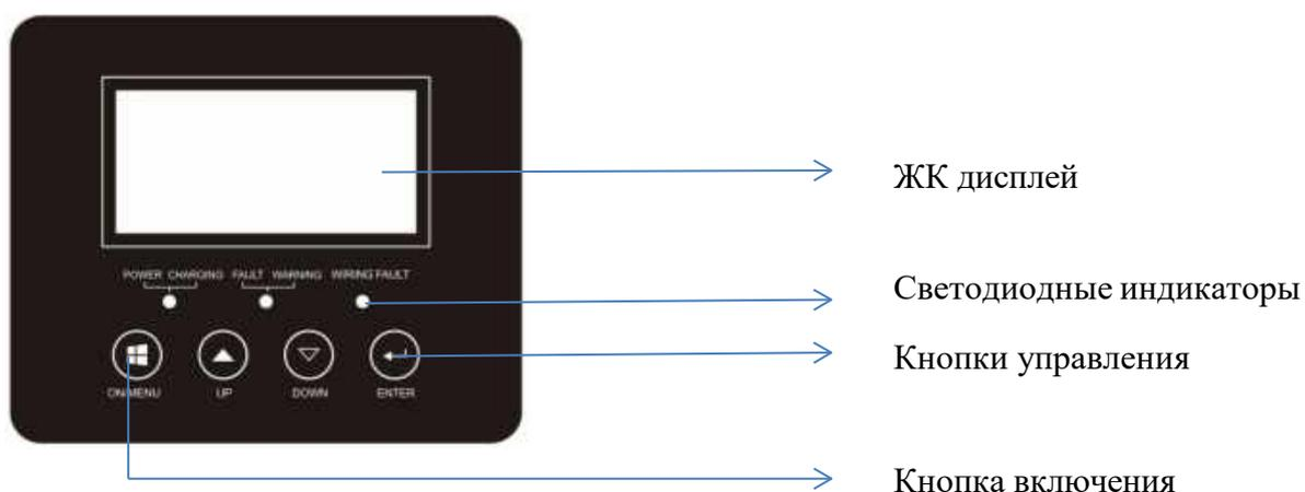
Рисунок 11 Дисплей контроллера
