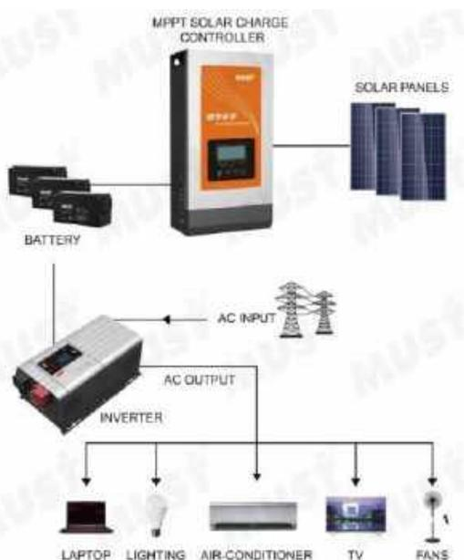
Рисунок 1 Принцип подключения солнечного контроллера Must PC1800F
