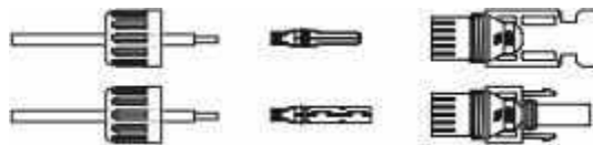
▲ Рисунок 4.8 Открутите накладную гайку от разъема
