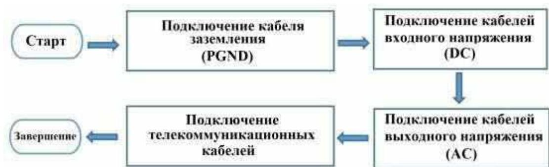
Рисунок 15 – Блок-схема для подключения проводов к инвертору
