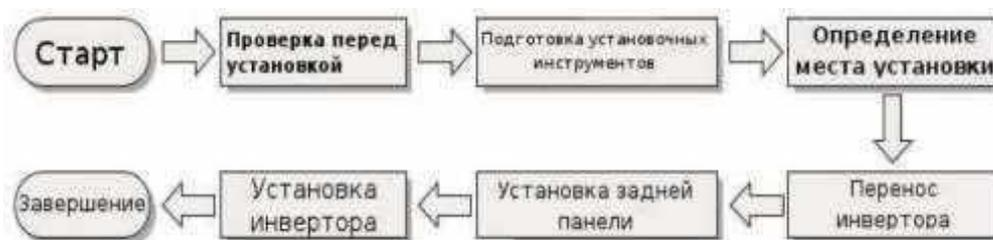
Рисунок 7 – Схема установки
