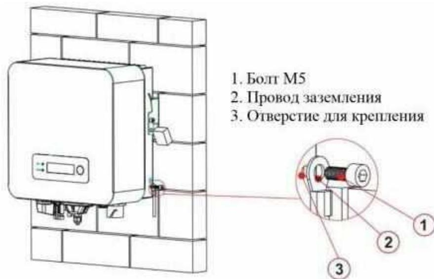
Рисунок 18 – Крепление инвертора
